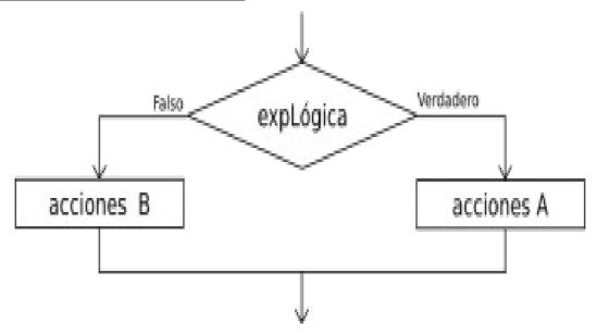
La secuencia de instrucciones ejecutadas por la instrucción Si-Entonces-Sino depende del valor de una condición lógica.
